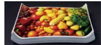
Las tintas con base de agua son propensas a deformaciones como ondulación y rizado.
